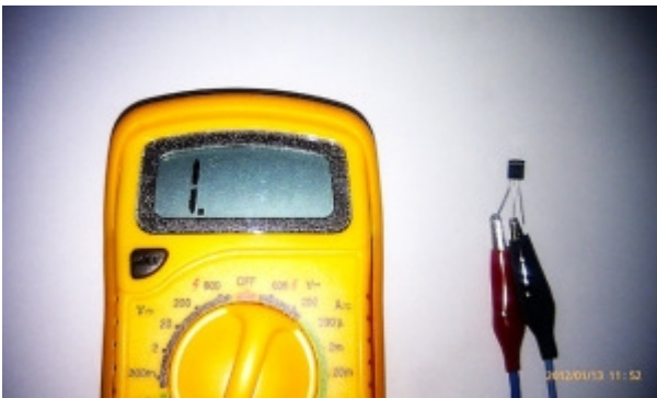
Giunzione C-B polarizzata inversamente ( la mezza cifra si accende perché abbiamo superato la porta ,valore elevato)
